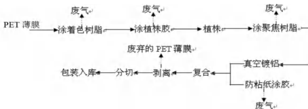
图 4-6 工程级（车牌级）反光膜生产工艺流程及产污环节
